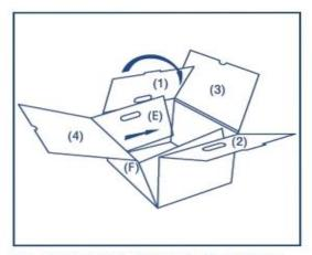
(3) INSERT (E) PANELS AS SHOWN FOLD FLAPS IN BY NUMBER ORDERS 1-4.
